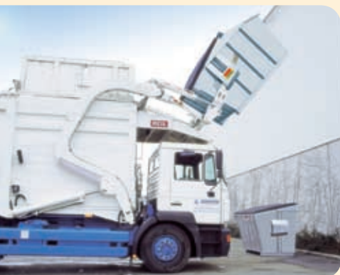
▲ Frontlader type FBR 5,0 m 3 met opnametassen aan beide zijden
